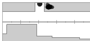
O Rastreamento de alvo de uma moeda canadiana de 10¢ de 1998 (aceite) e de um prego diretamente adjacente (rejeitado).
